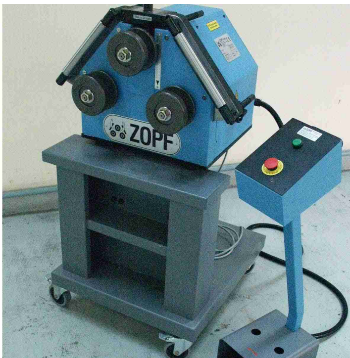
Bâti robuste en acier mécano-soudé Commande a pédale - Nouveau look
