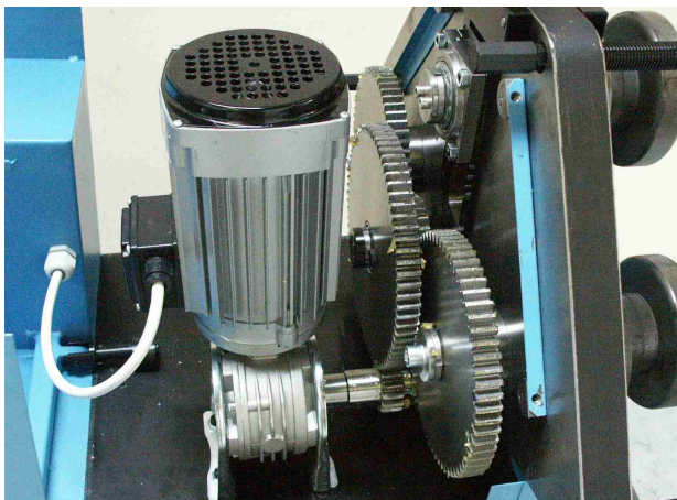
Nouveau réducteur et nouvelle pignonnerie
